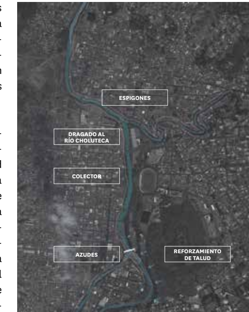
Obras sobre el cauce del Río Choluteca
